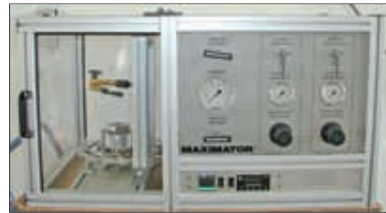
Versuchseinrichtung zur Analyse von Einflüssen auf verschiedene Drucksensoren
