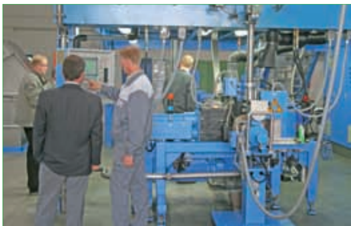
Vorführung im BKG-Technikum: Herstellung von LLDPE-Mikrogranulat Foto: Kreyenborg
