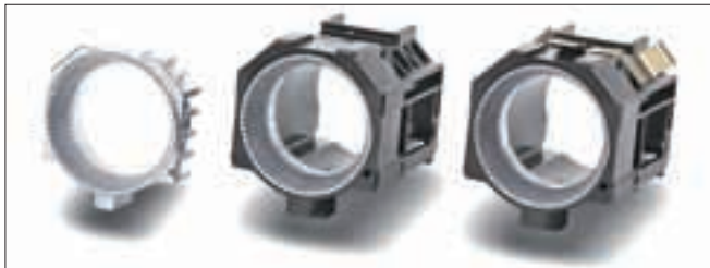
Fertigungsstufen des Sperrschiebers (v.l.): Einlege-teile (Druckguss), umspritztes Einlege-teile und komplett montierter Sperrschieber
