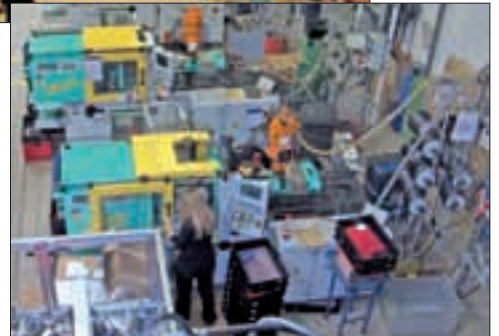
Auch die Praxis kam beim Technologietag nicht zu kurz. Das Produktionswerk 2 verfügt über einen Maschinenpark von insgesamt 40 Spritzgießmaschinen mit Schließkräften von 1.50, 3.500 und 2.500 kN (aktuell neu angeschafft) Fotos: K-ZEITUNG
