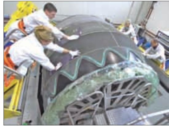
Schubumkehrgehäuse-Fertigung im FACC-Reinraum
