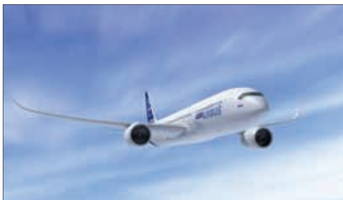
Der A350 mit Rumpf in CFK-Bauweise wird die erste Airbus-Maschine sein, die zum größten Teil aus Faserverbundwerkstoffen besteht, der Composite-Anteil wird 53 Prozent am Gesamtgewicht betragen Foto: Airbus
