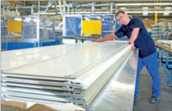
Stranggezogene glasfaserverstärkte Profile als Seitenverkleidungen für Nahverkehrszüge werden im Pultrusionsverfahren hergestellt
