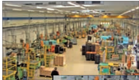
Auch die Praxis kam beim Technologietag nicht zu kurz. Das Produktionswerk 2 verfügt über einen Maschinenpark von insgesamt 40 Spritzgießmaschinen mit Schließkräften von 1.50, 3.500 und 2.500 kN (aktuell neu angeschafft) Fotos: K-ZEITUNG
