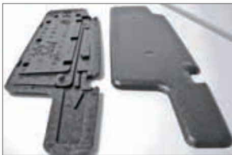
Gerade in Sonnenblenden kommt es durch die Wirkung verschiedener Werkstoffe aufeinander häufig zu Quietschgeräuschen Fotos: JSP
