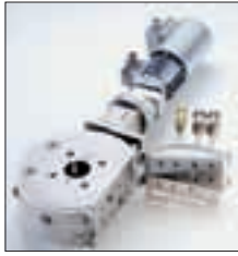
Dank des Online-Viskosimeters erkennt der Verarbeiter Prozessschwankungen und kann frühzeitig Gegenmaßnahmen ergreifen
